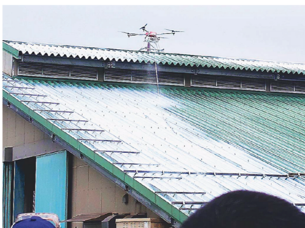
ドローンで牛舎の屋根に遮光剤を散布、80人が参加したセミナー
